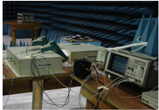
[그림 15] 전도성감응 시험 셋업
