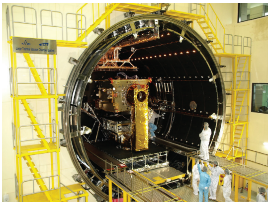
[그림 6] Preparation of COMS thermal vacuum test
